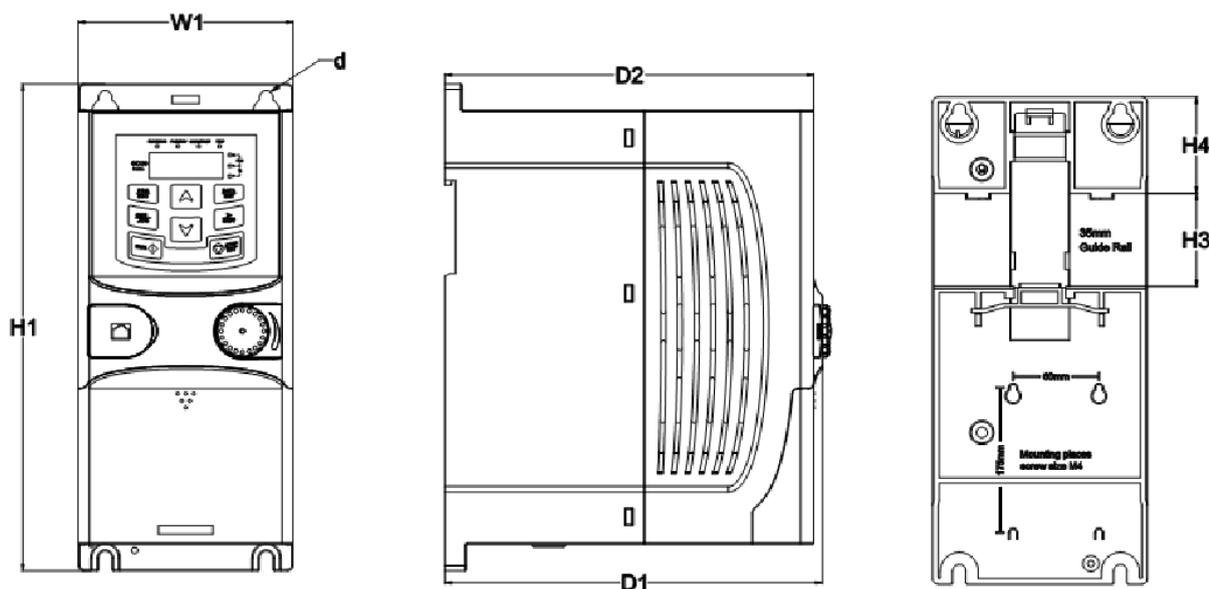
Montage sur rail des variateurs de 1PH 200 V/3PH 380 V ( $\leq 2.2$  kW) et 3PH 200 V ( $\leq 0.75$  kW)
