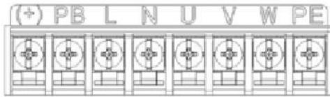
Figure 3-4 : Circuit principal 1PH Bornes (monophasé)
