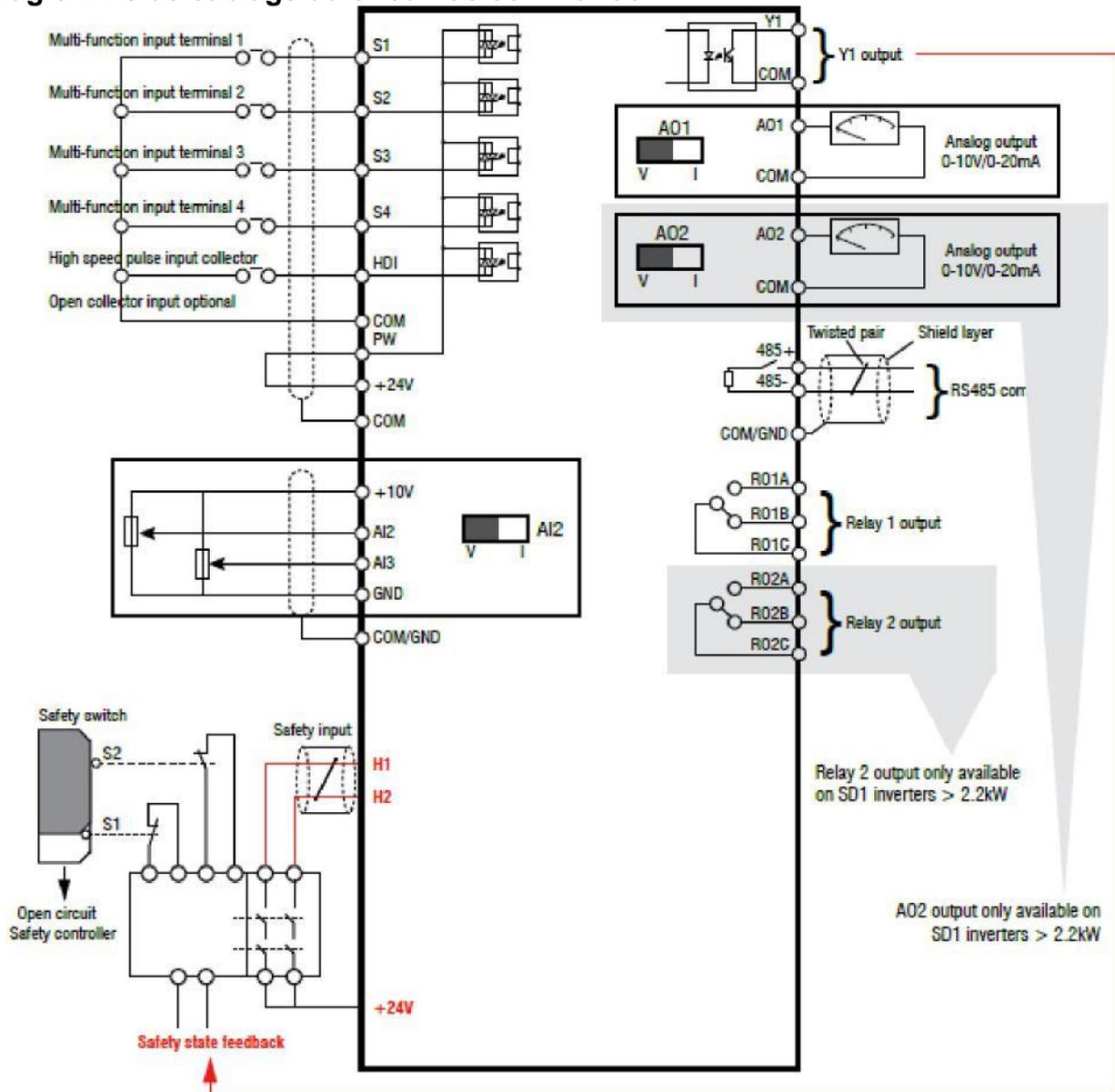
Figure 3-9 : Câblage du circuit de commande
