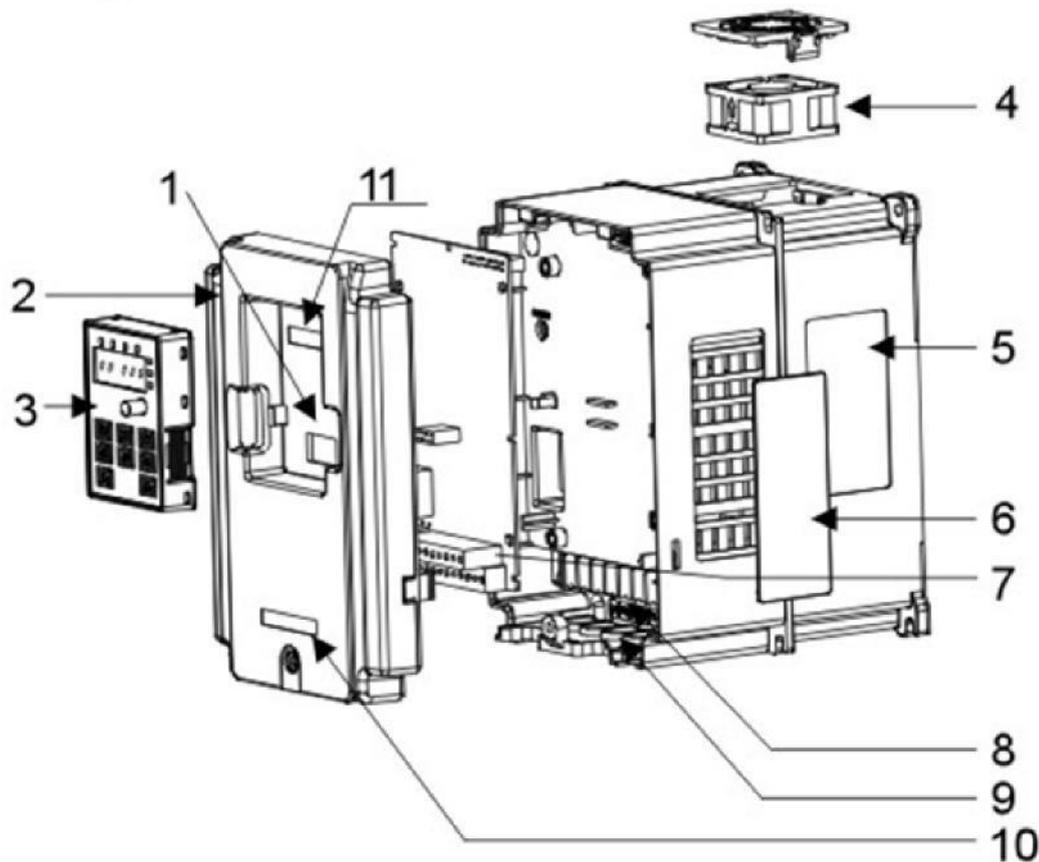
Figure 2-4 : Construction du produit (triphase 380 V, ≥4 kW)
