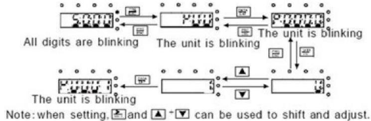
Figure 4-3 : Diagramme de modification des paramètres
