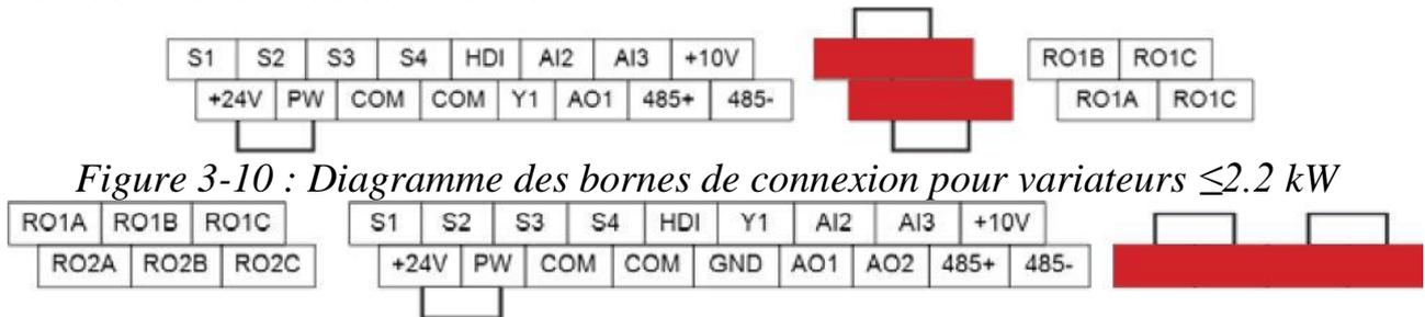
Figure 3-10 : Diagramme des bornes de connexion pour variateurs  $\leq 2.2$  kW
