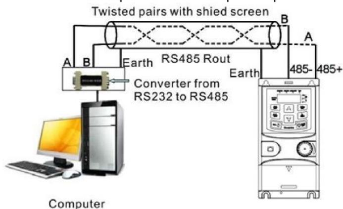
Figure 7-1 : Connexion physique en application unique RS485
