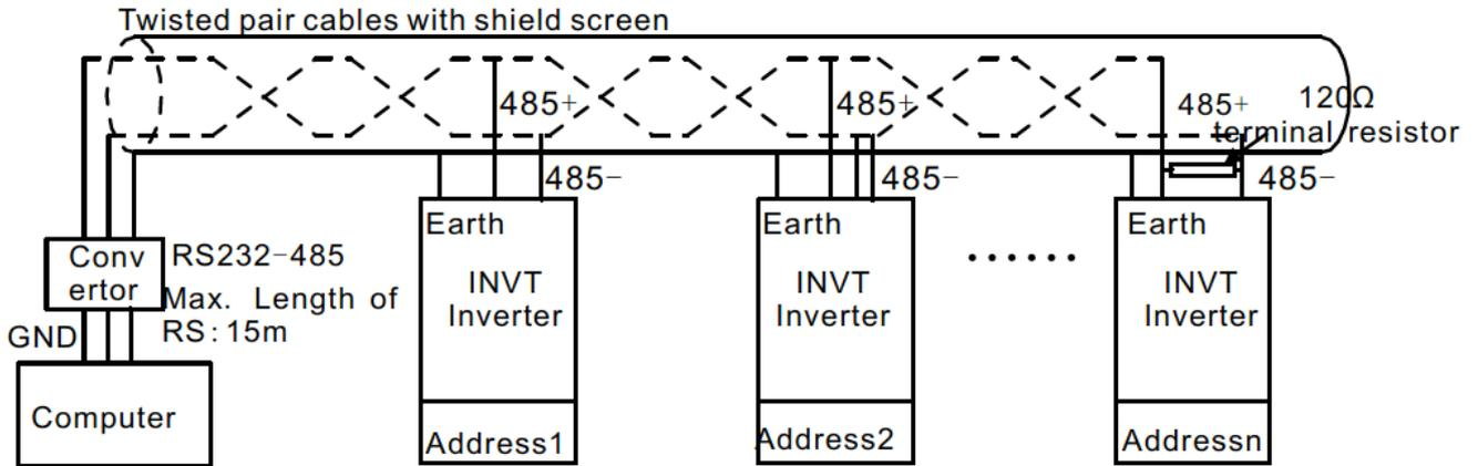
*Figure 7-2 : Applications type connexion en chaîne*
