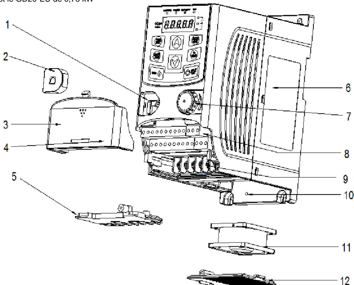
Figure 2-3 : Construction du Produit (triphase 380 V, ≤2.2 kW)
