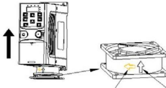
Figure 6-1 : Installation du ventilateur des variateurs 1PH, 200 V,  $\leq 2.2$  kW
