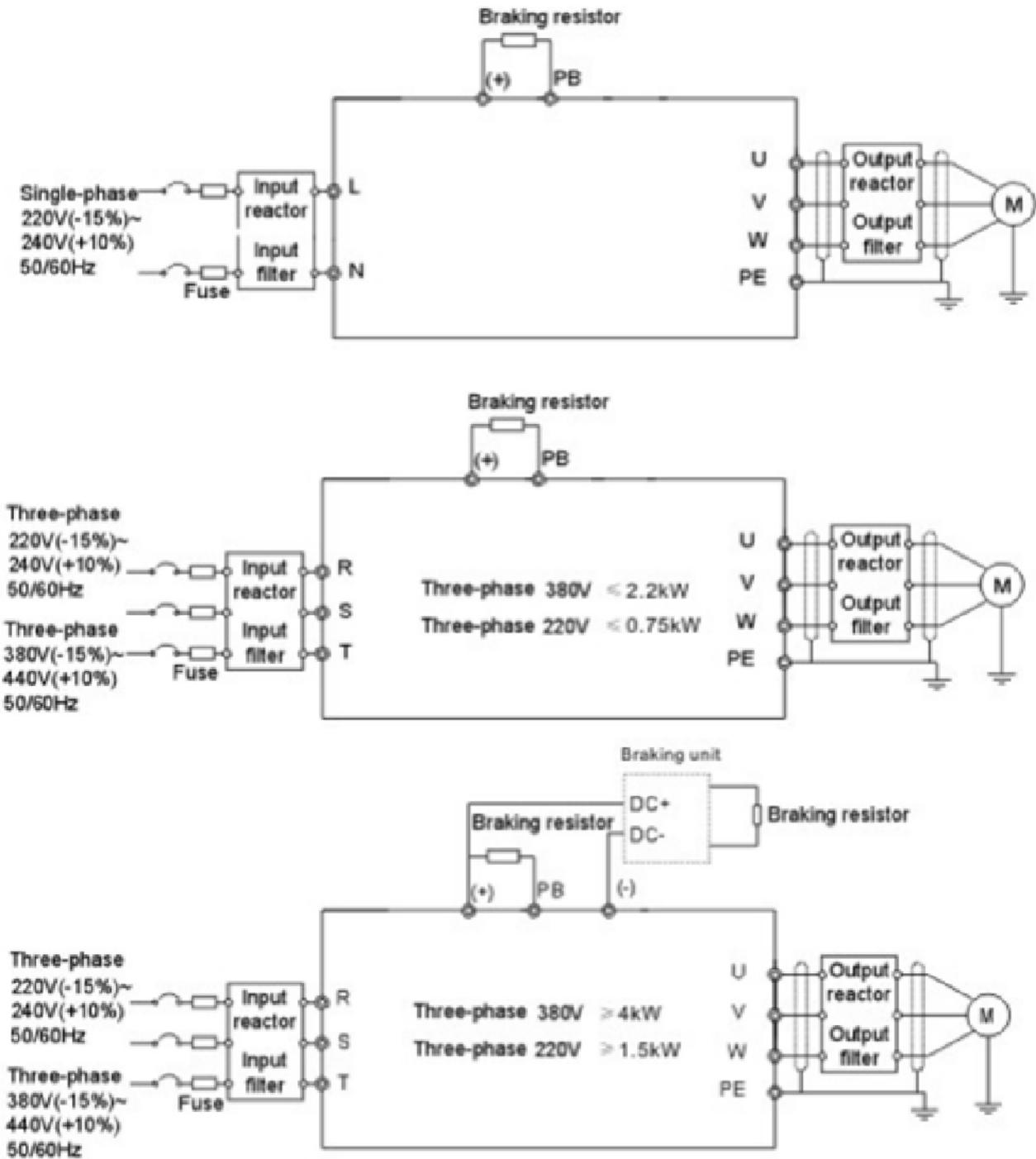
Figure 3-3 : Schéma de connexion du circuit principal
